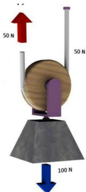
2-сурет. Жылжымалы блок
